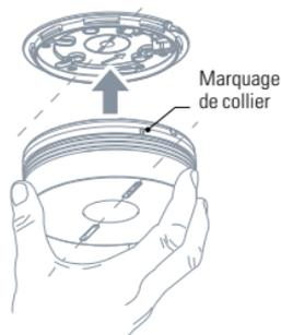
En appliquant une pression légère, appuyez et tournez Eve Smoke dans le sens des aiguilles d'une montre jusqu'à ce qu'elle se verrouille en place.
