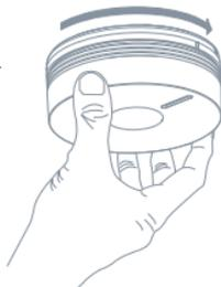
Tras instalarlo correctamente, el LED amarillo parpadeará rápidamente, seguido por un destello cada 10 segundos, lo que indica que su Eve Smoke es totalmente funcional y está listo para su uso.
