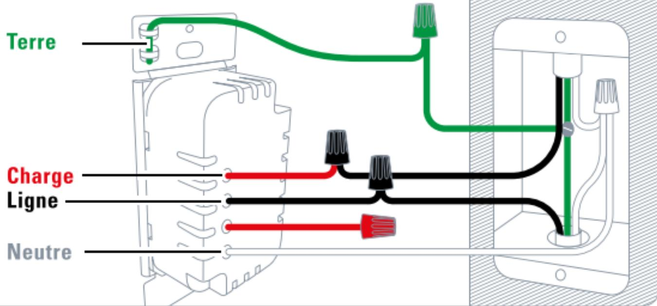
3 Remplacer un va-et-vient
